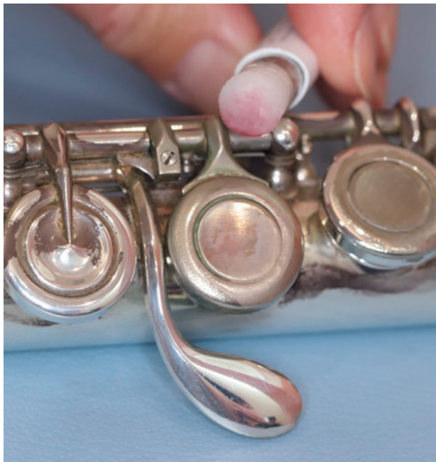
図 30 金属アレルギー発症例に使用されていたフルートキー (指が接するパーツ) より、ニッケルの溶出が確認された。
