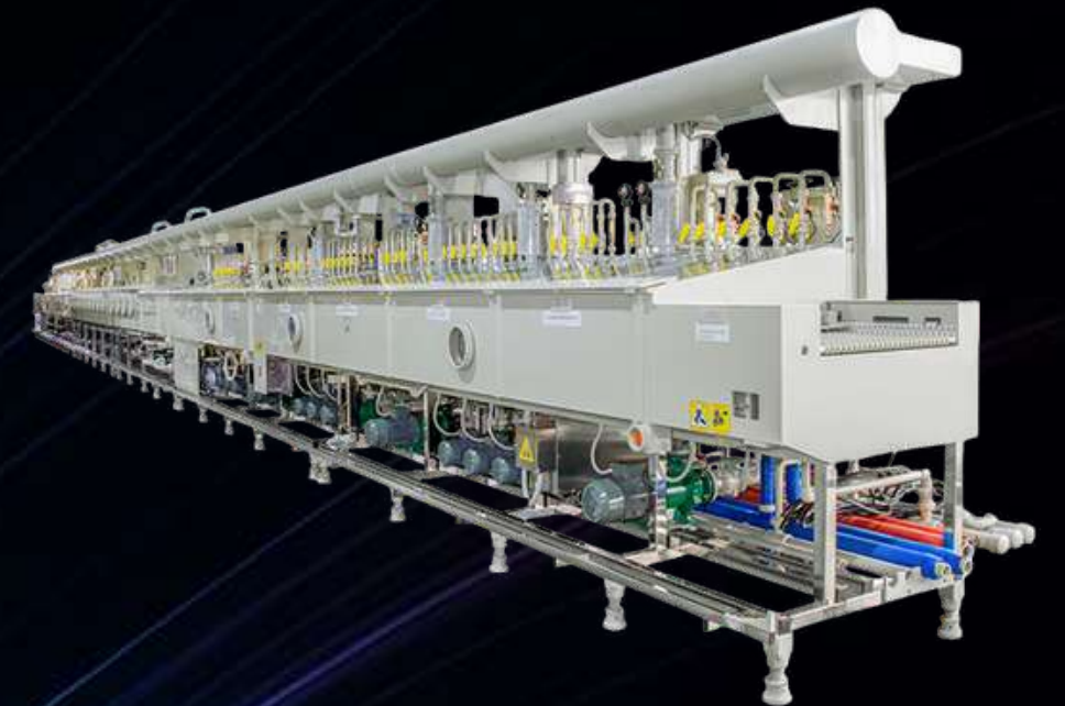
水平化學錫設備
