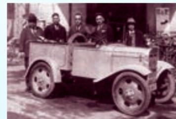
1931年、水冷式単気筒500cc1/2トン積小型として当社が試作に成功した小型トラックは「京三号」と名付けられ、翌年改良の上量産が開始されました。1937年に自動車メーカー数社が参加した富士登攀（6合目まで）のテスト走行では、京三号をベースに改良を加えた四輪駆動車のみが6合目に到達して優れた性能を証明しました。戦時体制が進むにつれて資材枯渇の影響を受けて1938年に製造が中止されましたが、それまでの約7年間で合計2,050台が生産されました。戦後、自動車の製造が再開されることはありませんでしたが、高品質、高性能の製品を生み出すDNAは今に至るまで連続と受け継がれています。
