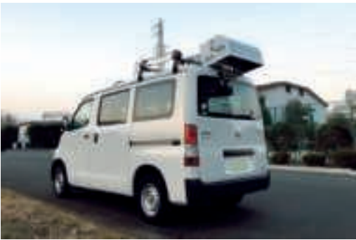
「リコー 路面簡易点検支援サービス」 可搬式装置 車両搭載イメージ
