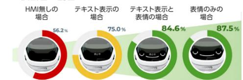
自動運転バスの前を横切って横断する時の不安感に対する実証実験でのアンケートの結果、e-Face\*による表情などの表示により、運転手とのアイコンタクトができないことに対する不安を払拭する効果が見込めることが確認されました。
