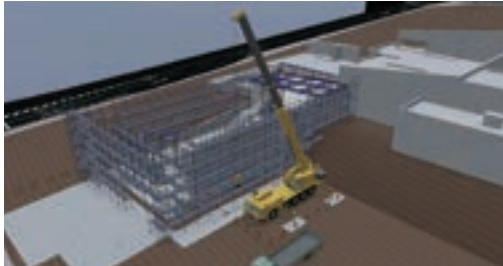
BIM検討図(鉄骨工事・仮設工事)
