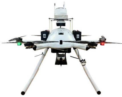
上空気象観測用ドローン「R-SWM®」
