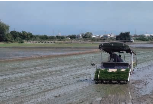
東アジア：可変施肥田植機での田植え作業
