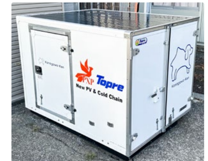
コンテナ屋根に、超軽量・薄型・高耐久でどこにでも貼り付け可能な「曲がる太陽電池システム」を搭載
