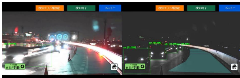
左：従来品、右：処理あり(ライトなどの逆光を抑え車両を正しく認識) 画像処理技術の効果(イメージ)
