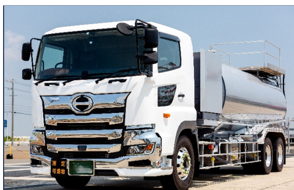
アスファルトを運ぶローリー
