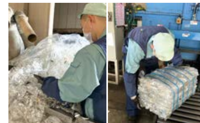
使用済みペットボトルのリサイクル作業（減容機への投入・結束）
