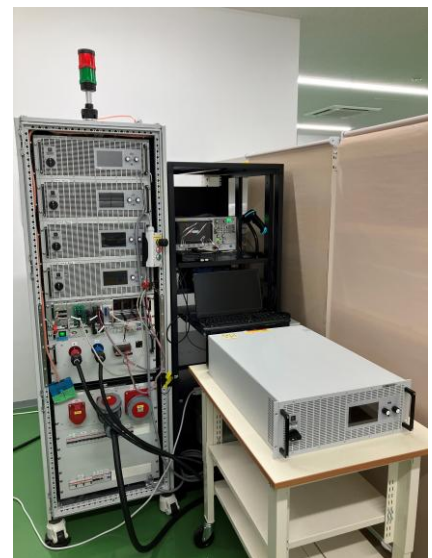
奥：EA 社の校正装置(ラック内) 手前：被校正対象物
