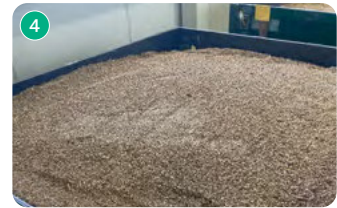
車輪の切削や、金型・治工具等の製作時に排出される金属くずをリサイクル
