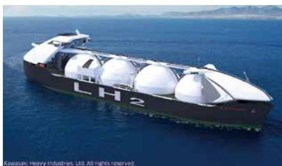
160,000m³型液化水素運搬船コンセプト図
