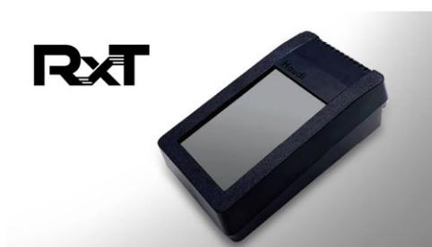
「RxT-01」は、ハウディと東京大学情報基盤センターの共同研究により生まれた、ネットワーク非接続環境での高速・大容量データ転送を可能とする IoT デバイスです。セキュアな構造と多様な接続性を備えており、USB メモリの代替として、機密性の高い研究データの効率的な搬出と管理を実現します。
