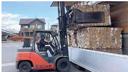
クランプリフトでの古紙の積込作業
