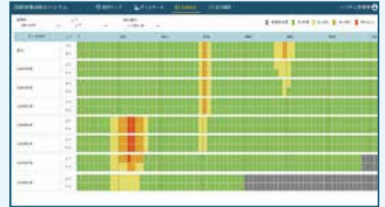
損傷箇所をヒートマップで時系列表示
