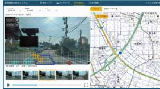
撮影画像による損傷箇所の詳細把握
