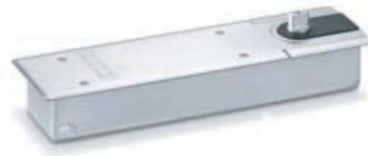
根據EN 1154，尺寸為3-6的關閉力可通過TS 550 NV進行調整。安全閥提供保護，保護故意超負荷。無段保持打開機構允許80°-165°的打開角度。多功能性和強大的性質，TS 550 NV意味著它非常適用於經常使用的區域，例：辦公樓和房屋入口。強化，高品質，即使經多年使用，蓋板也能確保出色的整體外觀。地彈簧配有扁平錐形主軸，水泥箱和安裝說明（不包括蓋板）。
