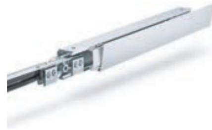
配備GEZE Levolan 60 SoftStop，帶有單側或雙側吸入式緩衝器，可實現高達60kg的滑動元件沒有額外的門頁處理。雙面吸入式減震器甚至可用於770mm的超薄門扇寬度。緩衝器動作作為門終點前10公分。門扇幾乎無聲地自動引導到最終位置。避免撞到框架或端部止擋，幾乎排除了被夾傷的危險。耐用次數達到十萬次。
