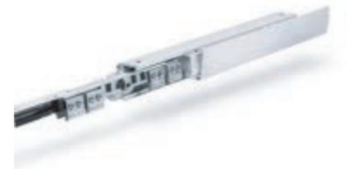
配件已安裝使用Levolan Smart固定安裝系統，從前面快速輕鬆地進行操作。所有可見部件均採用銀色EV1表面處理，不銹鋼光學元件或RAL顏色。可選配可單向或雙向緩衝之GEZE Levolan 120 SoftStop，可輕柔引導滑動門扇，並安全地進入最終位置，沒有擠壓或撞擊框架的風險。集成的脫軌保護功能自動啟動，在門扇高度調節時，提供額外的安全性。緩衝器動作為門終點前10公分。然後門扇幾乎無聲地自動引導到最終位置。Levolan 120 SoftStop可以改裝，並使滑動門適應不斷變化的用戶要求。
