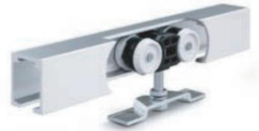
陽極氧化合金材料中的軌道減少了磨損，並且還保證了增強的防腐蝕性。由於門頁之間的距離並且可以使用牆壁支架選擇牆壁，可以根據個別情況調整門，例如，用於精確安裝軌道磚石不均勻的地方。優雅的外形使Perlan 140非常適合安裝在可見區域。軌道也有曲面，根據不同需求提供緩衝版本的選擇GEZE Perlan 140 SoftStop，門輕輕放慢並自動拉入零位。該在門和配件上輕鬆收回到最終位置，從而延長了門的使用壽命。蓋澤Perlan 140 SoftStop完全隱藏在軌道中，總高度僅為40mm。它適用於515至1700毫米的頁寬，頁片重量可達80公斤。
