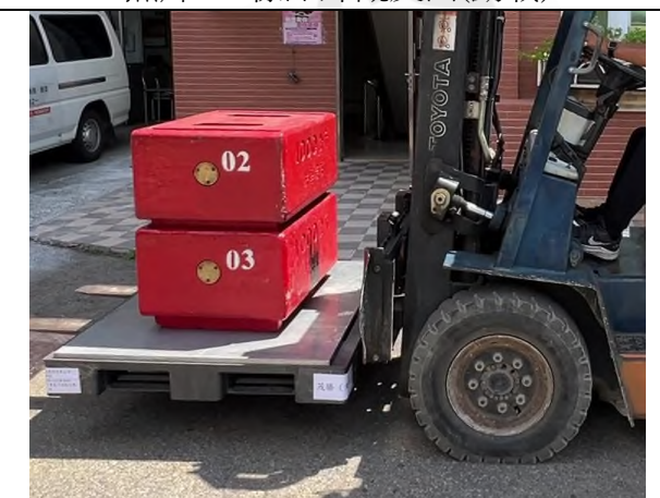
照片“F” 動態承載測試
