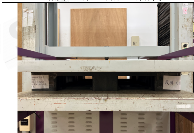
照片“E” 平面抗壓測試
