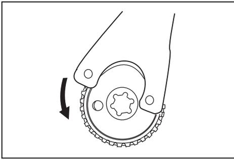
注：只要箭頭指向凹口，即可手動鬆開 Ezy nut。否則須使用鎖緊螺母扳手才能鬆開。將扳手插銷插入孔中並逆時針旋轉 Ezy nut。
