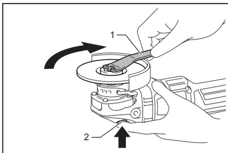
▶ 1. 鎖緊螺母扳手 2. 軸鎖
