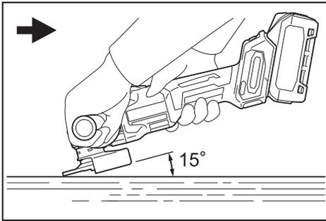
啟動工具，然後將砂輪或圓盤置於工件上。通常，砂輪或圓盤邊緣應保持與工件表面成 $15^{\circ}$ 角度。
