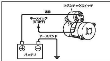
(3) キースイッチを移動装着する場合は、スイッチの水抜き穴が下になるよう装着してください。
