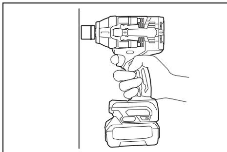
緊握工具，將衝擊套筒套在螺栓或螺母上。開啟機器並按固有緊固時間開始緊固。適當的扭力可能會隨著螺栓種類或尺寸、需緊固工件材料等的不同而不同。扭力和緊固時間的關係如圖所示。
