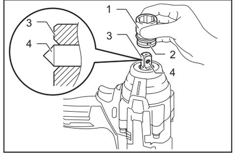
► 1. 衝擊套筒 2. 開孔 3. 方形打釘 4. 棘爪插銷
