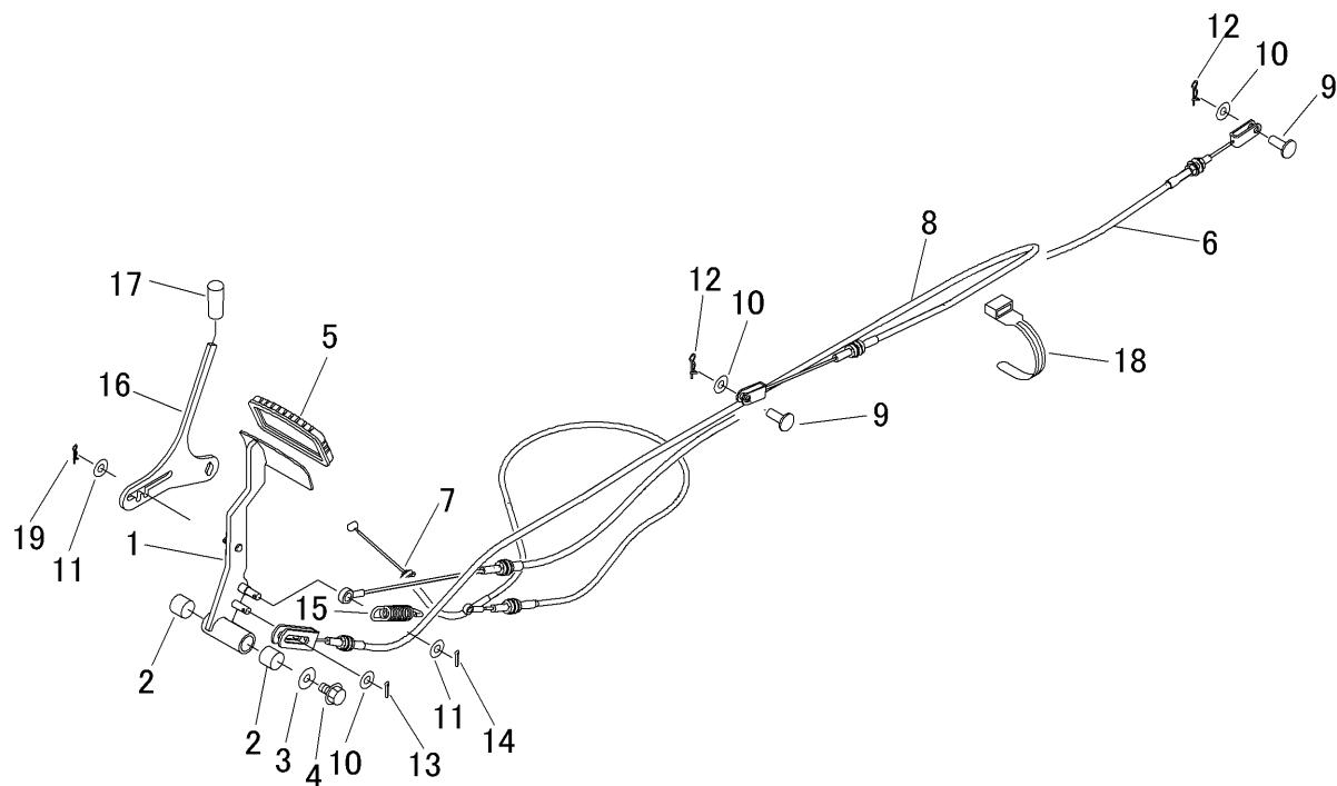
5347 330E 000 ブレーキ( 左 Long CE AU USA ) Brake( Left Long CE AU USA )
