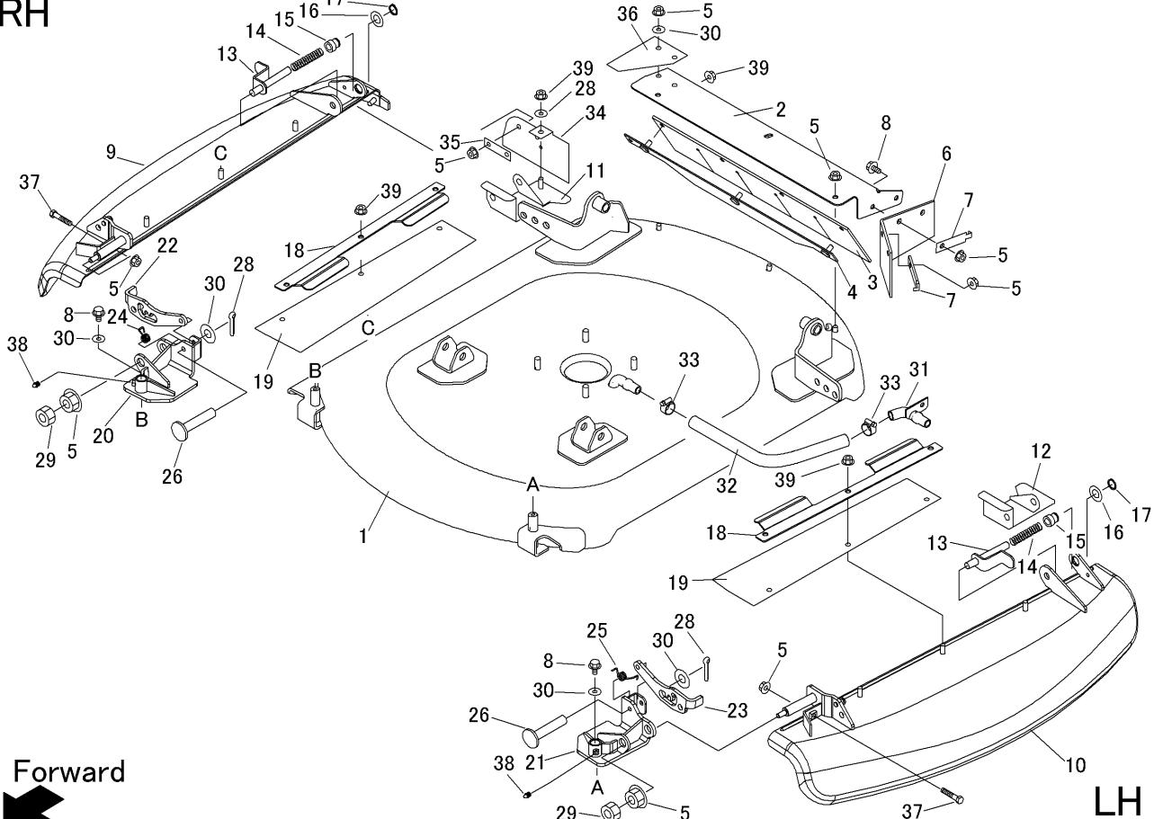
5347 410G 000 カリハカバー( CE AU USA ) Cutting Blade Shield( CE AU USA )
