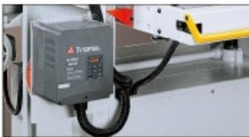
Frequency Inverter 變頻器
