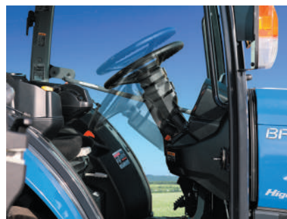
伸縮式 & 方向盤調節桿 ※伸縮功能不適用於Z型
