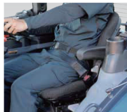
附氣壓避震座椅 附座椅安全開關（離座時PTO自動停止）
