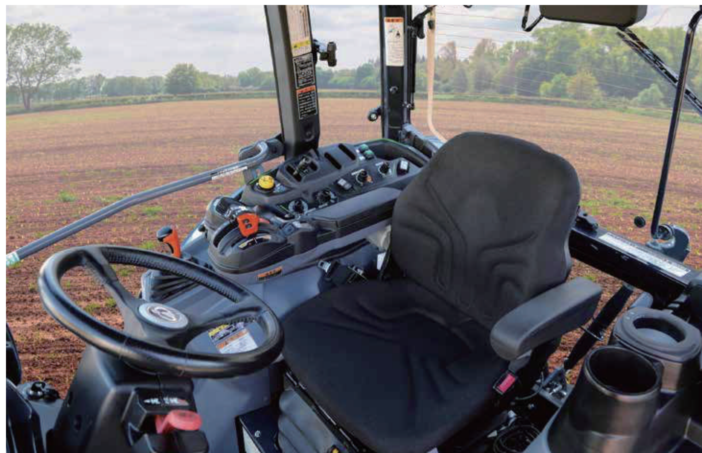
附氣壓避震座椅 附座椅安全開關（離座時PTO自動停止）
