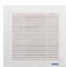
E-1305 $4,700 (110V) E-1305L $4,700 (220V) 浴室通風扇 機體尺寸: 245×245×150mm 開孔尺寸: 210×210mm 註: 1.功率21W 2.側排 (電容式馬達) 3.風量170CMH / 噪音29dBA
