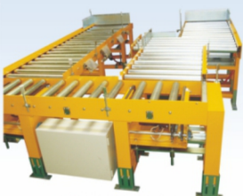
▲倉儲減料過邊設備
