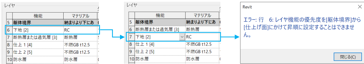
図 35 : 「下地[2]」と「断熱層または通気層[3]」の順序エラー
