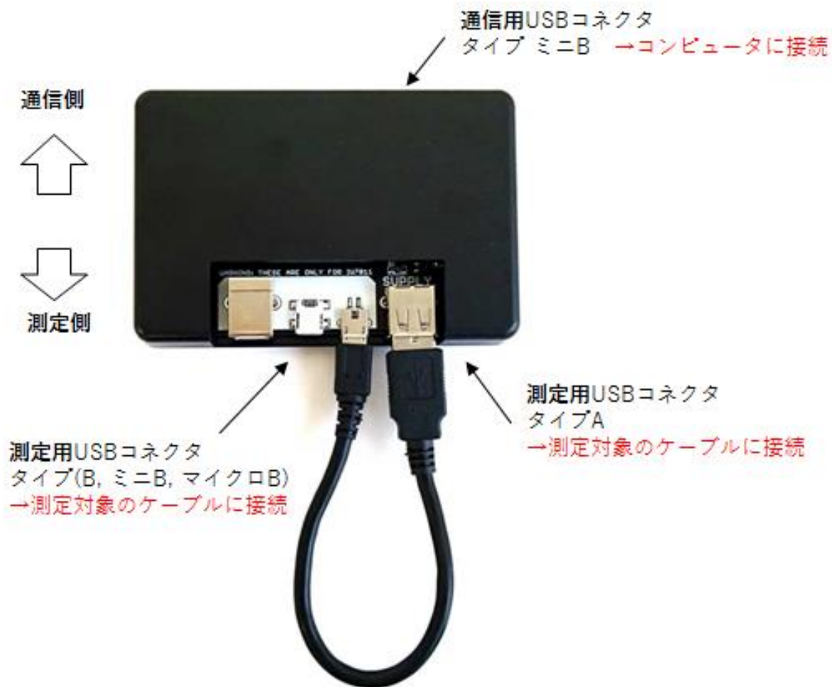
図 1 接続構成例 (USB TypeA – USB microB ケーブル測定例)
