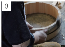
3 仮輪を打ち込んで固定し乾燥
