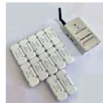
各ラック 温湿度計測無線子機
