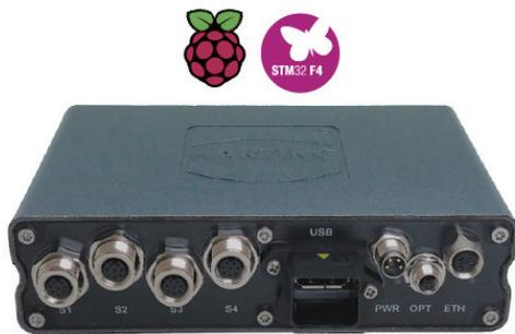
ラズベリーパイと並びIoT技術の主役であるArduinoやSTM32のようなヨーロッパ生まれの数百円の汎用マイコンチップを使えば、センサやアクチュエータを自在、高速に駆動できます。近年のマイコンはそのプログラム開発環境が劇的にユーザーフレンドリになっており、小中学生の電子工作やロボット競技でも汎用マイコンが活躍しています。産業用ラズベリーパイ MICA-R には、高性能マイコン STM32F4 シリーズを実装したカスタムボードがラインアップされています。入出力制御は STM32、その後の情報処理はラズパイという役割分担を実現することにより、産業用ラズベリーパイが適用できるアプリケーションが一気に広がりました。例えばこれまで PLC と FA パソコンを搭載していた AGV（自動搬送ロボット）も、4万円台の STM32 を搭載した MICA-R ですべての制御系を完結できるだけでなく、ラズパイがサポートする ROS（Robot Operating System）などの最新の工学系オープンソースソフトウェア資産をフル活用することができます。
