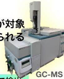
溶媒抽出(有機溶媒に溶ける) → 質量分析装置で検出
